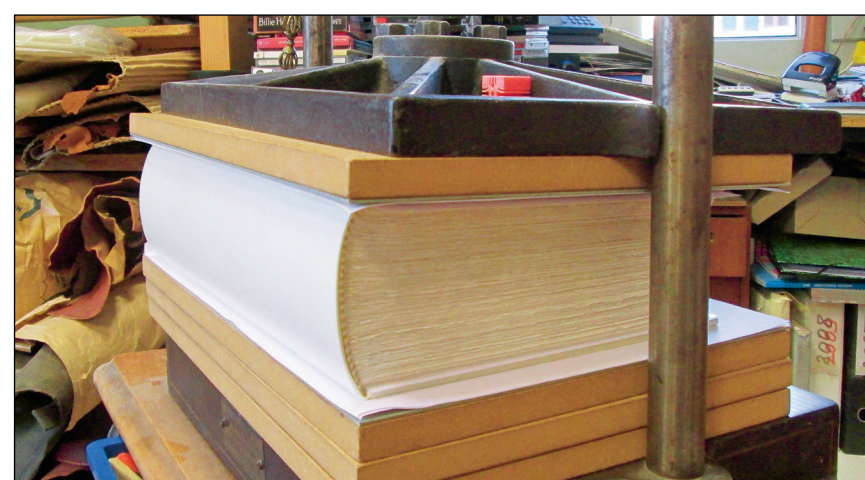
Mise en presse de l'ouvrage après couverture.
